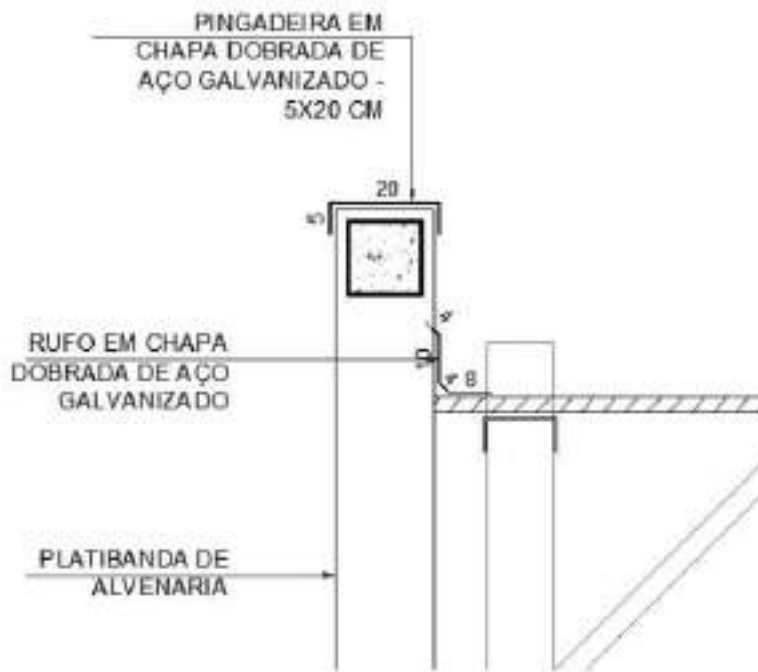
Figura 15 – imagem exemplificativa de detalhe de rufo/alvenaria e pingadeira
